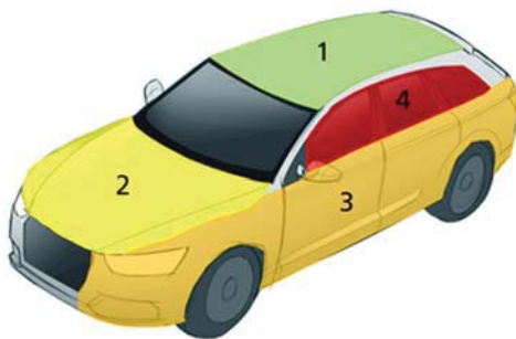
Abbildung 4: Integrationsstufen an Fahrzeugen am Beispiel von PKWs. Integrationsstufe 1 beinhaltet die Dachfläche von Fahrzeugen, Integrationsstufe 2 alle weiteren nicht-transparenten horizontalen Fahrzeugflächen wie Motorhaube und Heck, Integrationsstufe 3 die nicht-transparenten, vertikalen Seitenflächen von Fahrzeugen und Integrationsstufe 4 alle transparenten Flächen am Fahrzeug.
